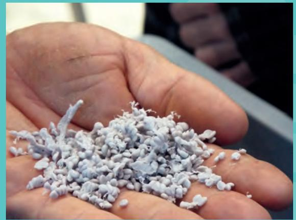
Fertiges Kunststoffgranulat, welches nach der Extrusion entsteht
